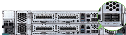
Zwei 12Gb SAS-Erweiterungsanschlüsse pro Controller
