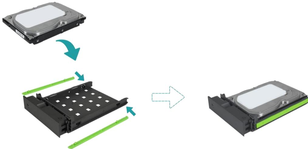
3. 將 2.5 吋磁碟/固態硬碟安裝於 LFF 磁碟托盤
