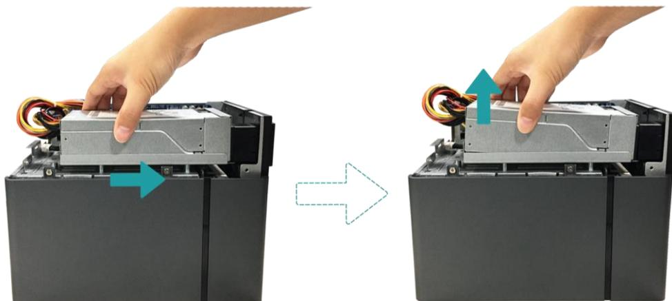
④ 移除鎖固的 4 顆螺絲後，將支架卸下。
