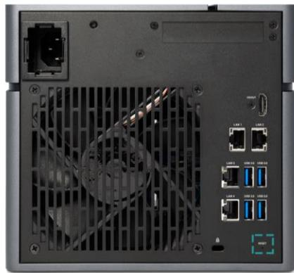
1. ネットワーク設定のリセット：リヤパネルのリセットボタンを3秒間長押しすると、短いビープ音が1秒間鳴ります。管理者パスワードとすべてのネットワーク設定がリセットされ、システム構成が以下のように戻ります。
