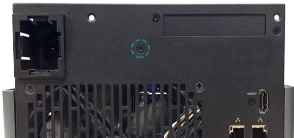
② 電源装置のネジを外します。
