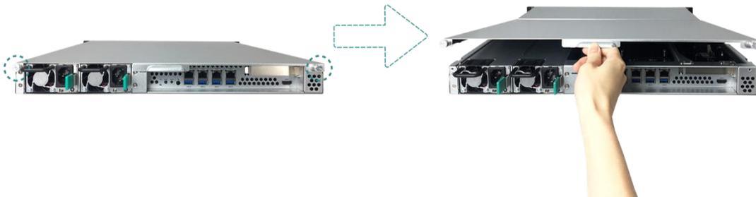
3. Halten Sie beide Enden des Gebläsemoduls und heben Sie es hoch, um es zu entfernen.
