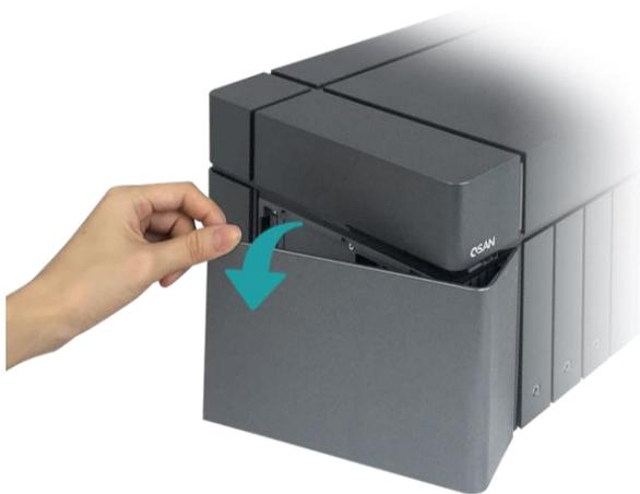
2. Installazione di un'unità SSD da 2,5" in un vassoio SFF.
