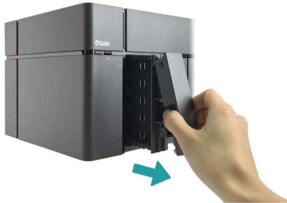
2. Installazione di un'unità HDD da 3,5" in un vassoio LFF.
