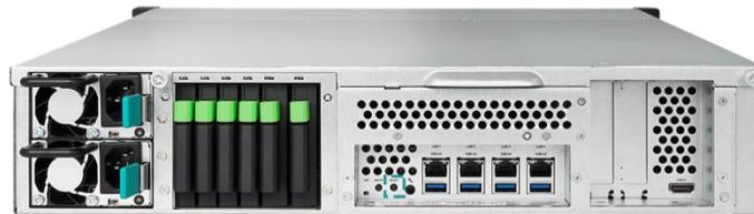
1. Netzwerkeinstellungen zurücksetzen: Drücken und halten Sie die Taste Zurücksetzen am Rückseite **3 Sekunden**, Sie werden 1 Sekunde lang einen kurzen Piepton hören. Das Administrator-Passwort und alle Netzwerkeinstellungen werden zurückgesetzt, die Systemkonfiguration ergibt:
