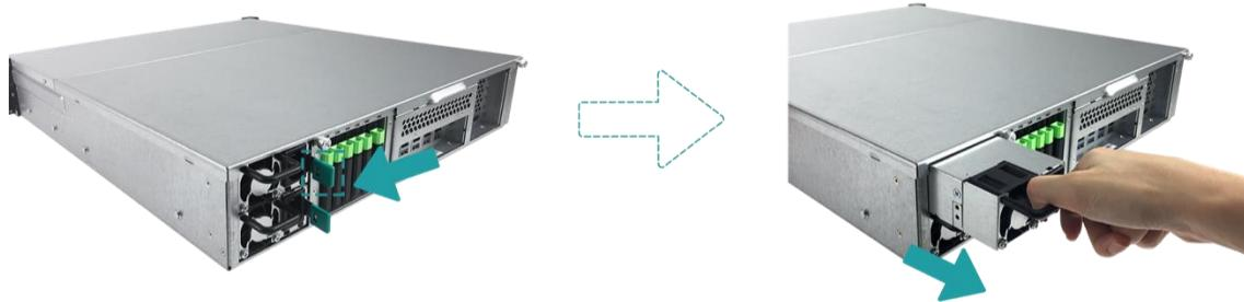
3. 새 PSU를 준비하고 소리가 날때까지 슬롯에 밀어 넣습니다. 부적절한 설치로 인한 잠재적 손상을 방지하기 위해 PSU의 방향이 올바로 설치되었는지 확인합니다.
