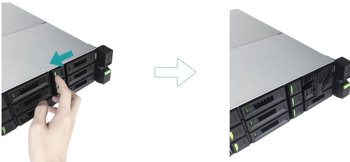
② 握住托盤手柄並取出磁碟托盤，重複步驟直到抽出所有磁碟托盤。
