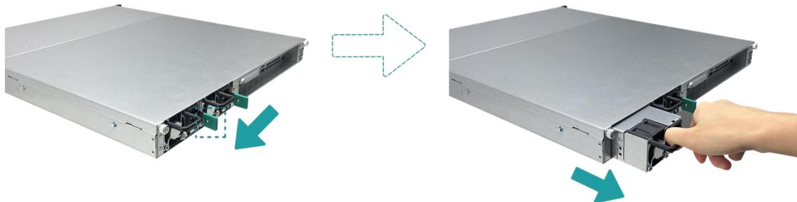
3. 將您準備好的全新電源供應器推入插槽內，直至聽到「喀」聲。請確認電源供應器的方向是否正確，以防止任何可能的損壞。
