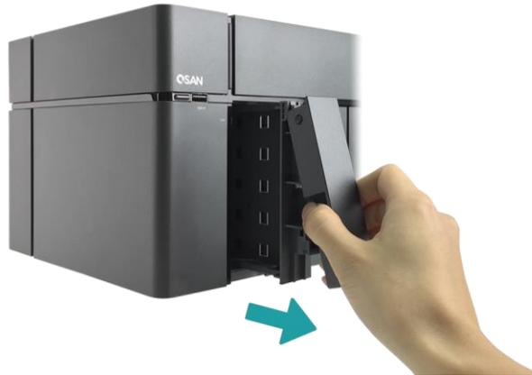
2. Instalación de un HDD de 3,5" en una bandeja LFF.
