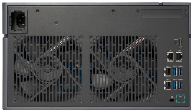
1. Restaurar la configuración de red: Mantenga pulsado el botón Reset, situado en el panel posterior, durante **3 segundos**; se emitirá un pitido durante 1 segundo. Se restablecerá la contraseña del administrador y toda la configuración de la red, con lo que la configuración del sistema quedará así:
