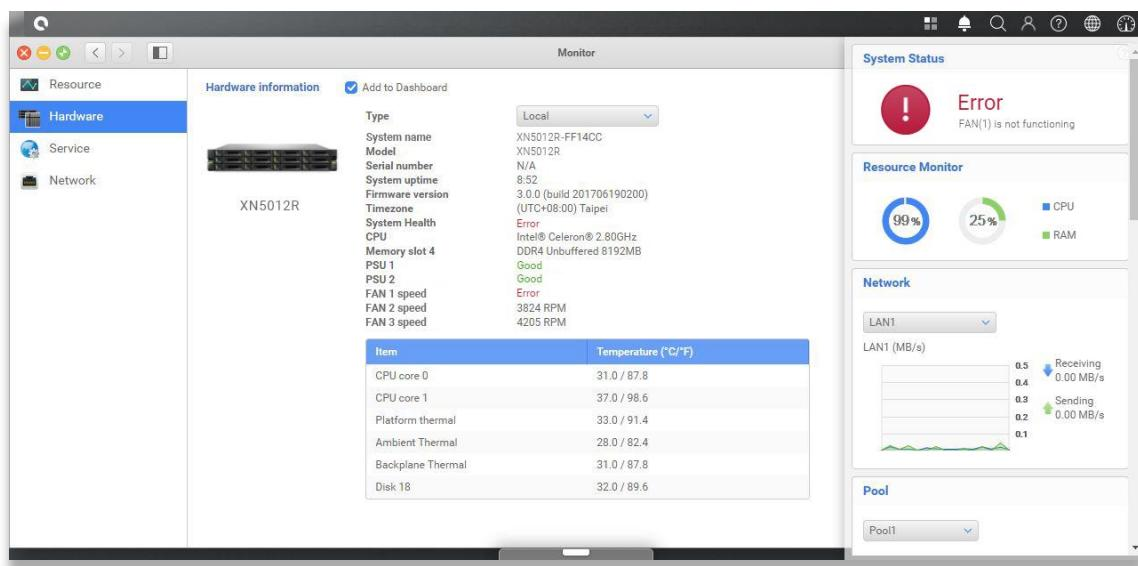
위의 에러 메시지가 발견되면 즉시 해당 팬 모듈을 교체해야 합니다. 고장난 시스템 팬을 교체하려면 [챕터 3.4 시스템 팬 교체](#)를 참고해 주십시오. 새 팬 모듈이 성공적으로 설치되면 QSM에서 분당 회전 수(RPM) 값이 표시될 것입니다.
