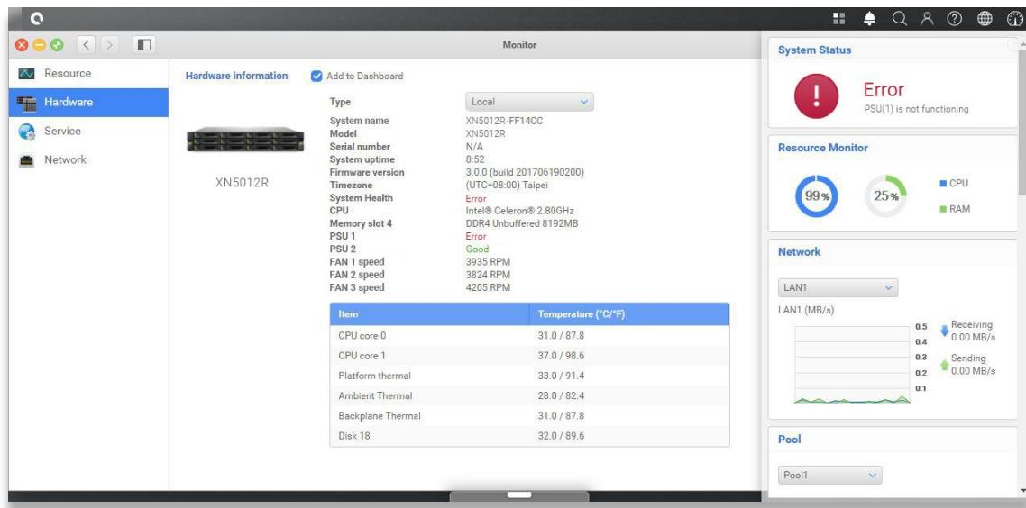
위의 에러 메시지가 발견되면 즉시 해당 PSU를 교체해야 합니다. 고장난 PSU를 교체하려면 [챕터 3.5 고장난 PSU 교체](#)를 참고해 주십시오. 새 PSU가 성공적으로 설치되면 PSU 상태 LED가 녹색으로 표시되고 QSM에 PSU 상태가 ‘Good(양호)’로 표시됩니다.
