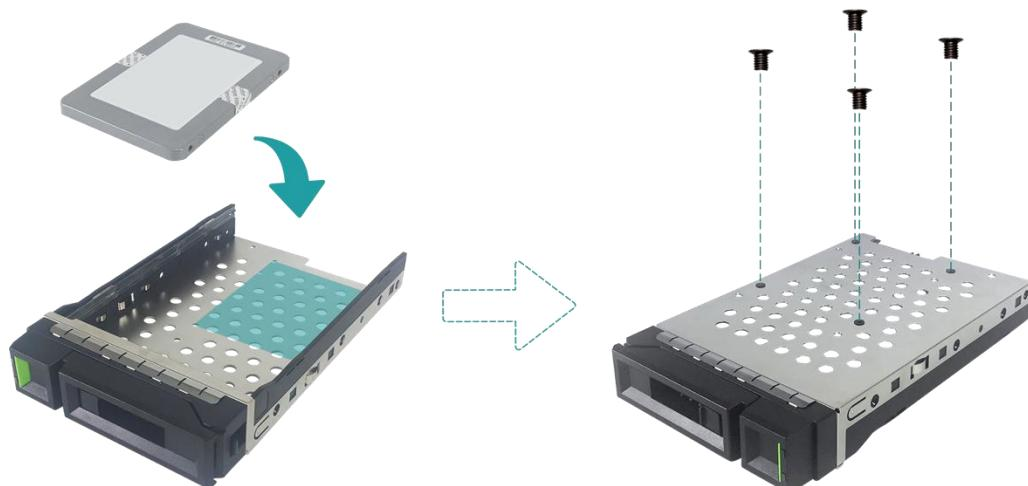
4. 将 LFF 磁盘托架装回机器
