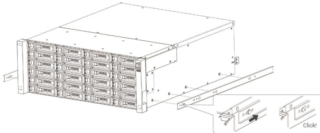
3. 將滑軌前端插入機架，並固定後端彈簧片。重複步驟直到安裝完左側及右側滑軌。
