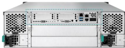
1. 關閉 XCubeNAS 以及移除電源線、網路線和其他連接到 XCubeNAS 的裝置，以避免任何可能的損害，並將您的 XCubeNAS 放置於平坦的表面上，以防止刮傷。
