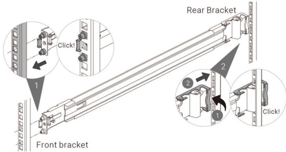
4. 依據以下步驟將機器正確安裝於滑軌上方。
