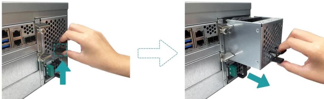
3. 準備新的風扇模組進行更換。將模組對齊插槽後，推入機箱直至聽到「喀」聲。請務必確認風扇模組的方向是否正確，以防止任何可能的損壞。
