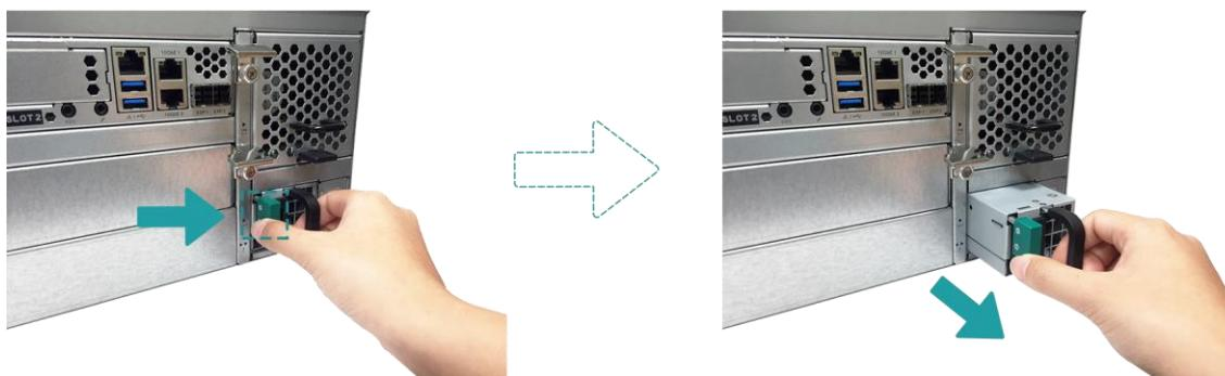
3. 將您準備好的全新電源供應器推入插槽內，直至聽到「喀」聲。請確認電源供應器的方向是否正確，以防止任何可能的損壞。
