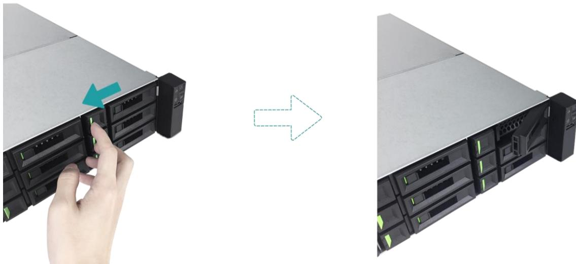
② 握住托盤手柄並取出磁碟托盤，重複步驟直到抽出所有磁碟托盤。
