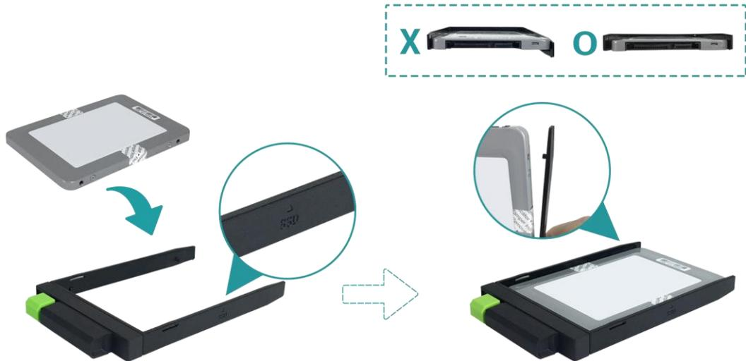
3. 将 SFF 磁盘托架装回机器
