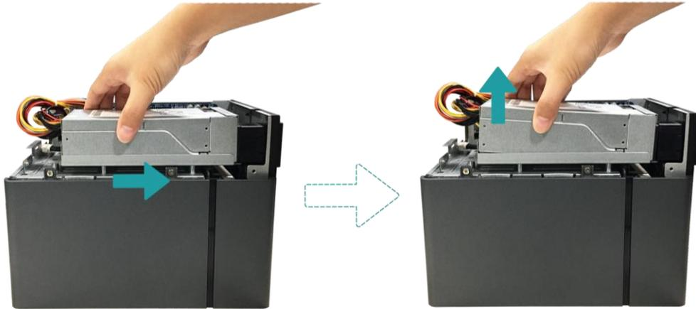
④ 移除锁固的 4 颗螺丝后，将支架卸下。
