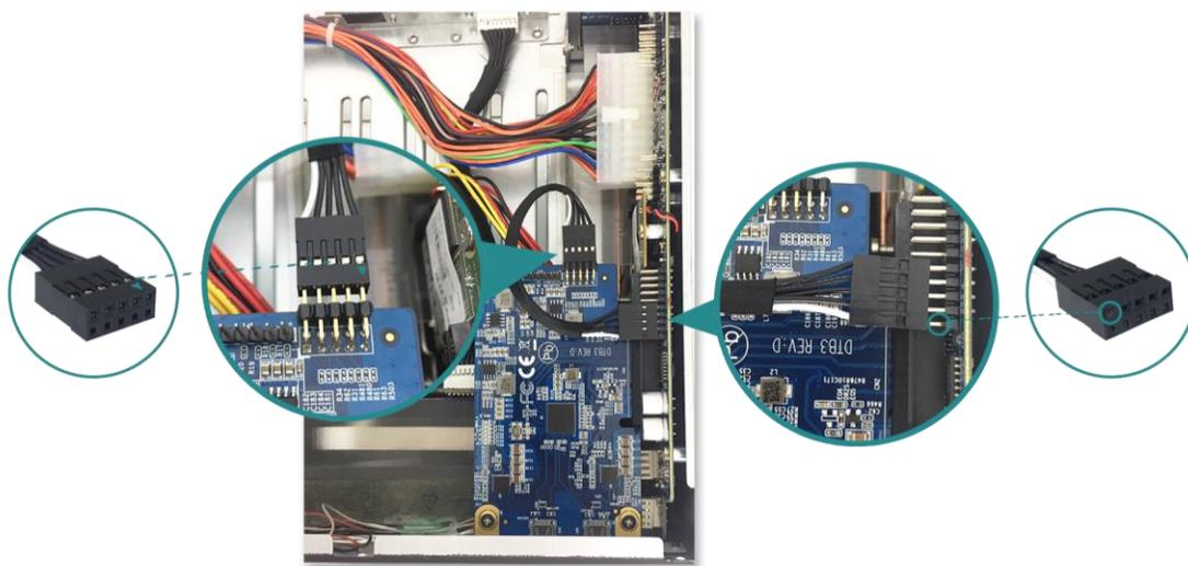
② 将连接线插至连接器上。
